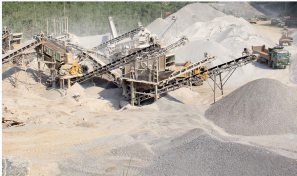
Dây chuyền khai thác chế biến đá vôi phục vụ sản xuất xi măng
