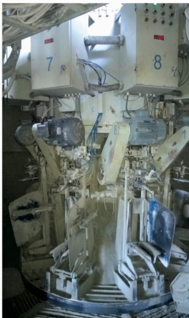
Máy đóng bao xi măng (120 tấn/h)
